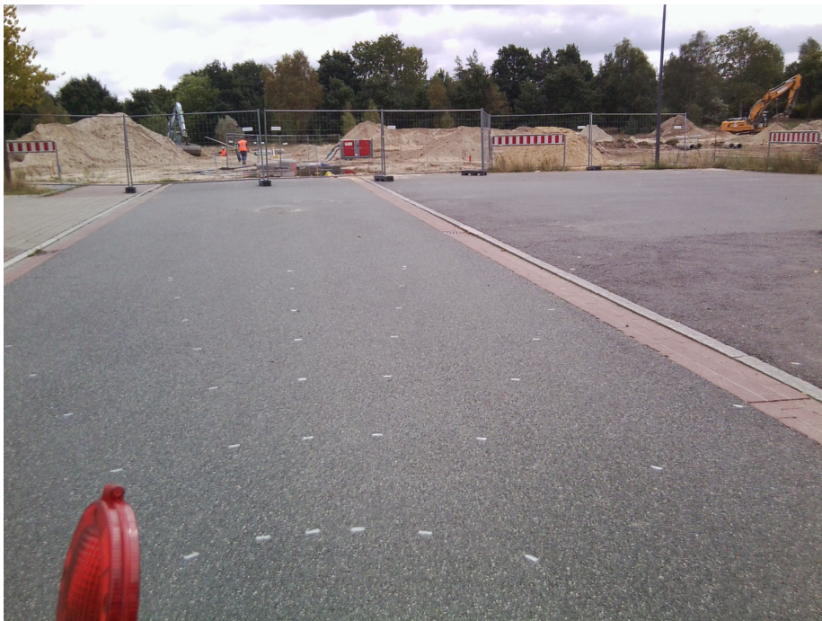
Abbildung 4.2: Testgelände für den Versuch vor der Baustelle aus Sicht des Roboters, Markierungen auf dem Boden für Geräuschpositionen.
