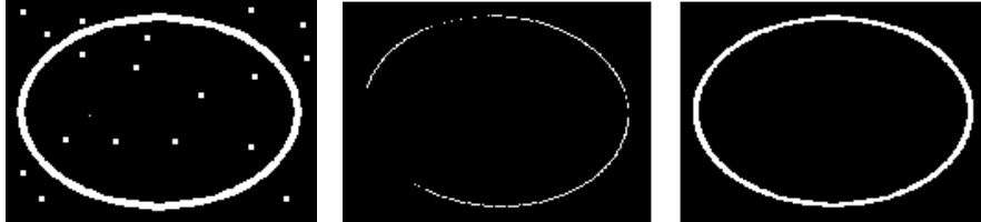
Abbildung 35: Von links nach rechts: Die Ausgangsellipse mit Störungen, eine Grafische Darstellung der Evaluationsfunktion und der Endsuchschlauch für die abschließende Ellipsendetektion
