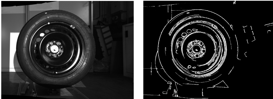
Abbildung 52: Testergebnis einer dunklen Felge auf dunklem Reifen. Das Kantenbild rechts zeigt die Erkennungsschwierigkeit aufgrund vieler starker Kanten durch einen geriffelten Übergang zwischen Felge und Reifen.
