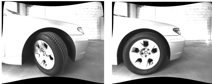
Abbildung 67: Beispielbilder der verwendeten Aufnahmen. Links das eingeschlagene Rad zur Erkennung eines Lenkeinschlags, rechts eine Aufnahme des vorbeifahrenden Autos
