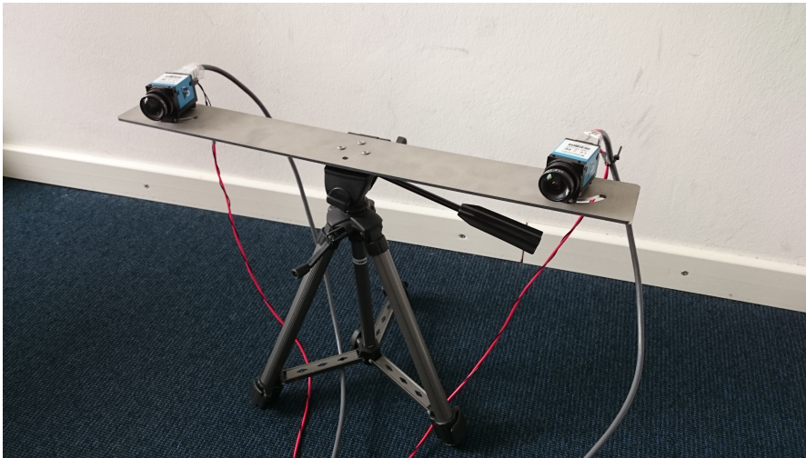
Abbildung 5.2: Die Industriekamera DMK33UX265 in der entworfenen Stereokonfiguration.
