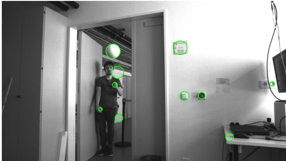
Abbildung 6.4: Erkannte Kreise (grün) in einem Bild der linken Kamera.
