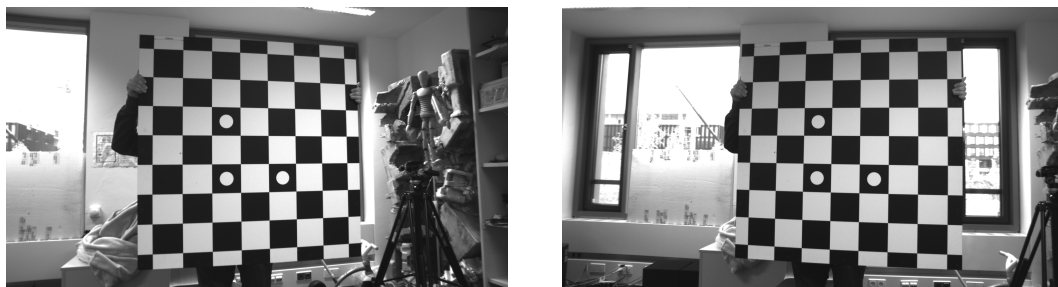
Abbildung 6.3: Beispiel einer Kameraaufnahme, die zur Stereokalibrierung des Kamerasystems verwendet wurde. Die Perspektive stammt jeweils aus Sicht der linken bzw. rechten Kamera.
