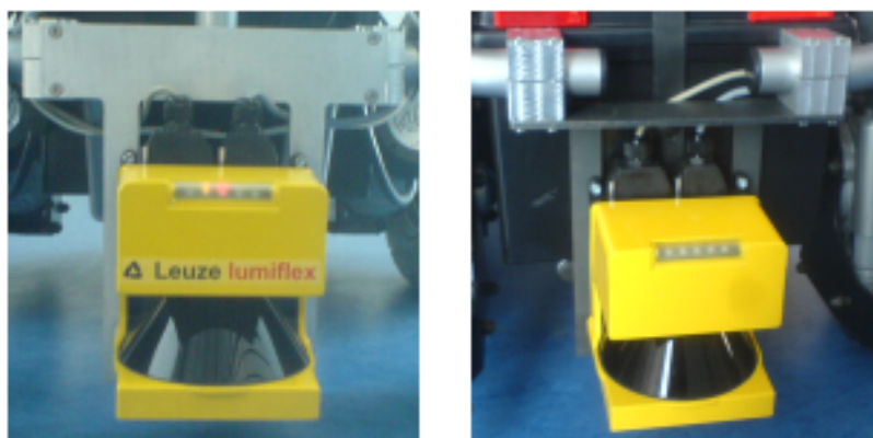
Abbildung 10: Die Halterungen der Laserscanner, Links: Vorne, Rechts: Hinten
