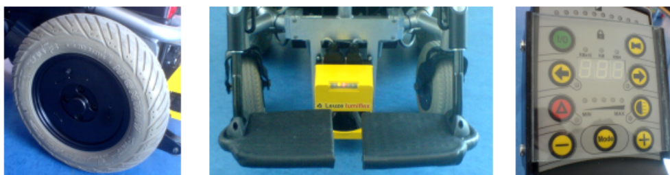
Abbildung 7: Die baulichen Veränderungen für maximale Sicherheit der Besucher Links: Radkappen, Mitte: Fußstützen, Rechts: Abdeckscheibe
