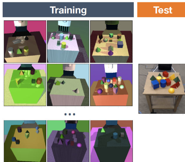
Abbildung 3.4: Generierte, randomisierte Bilder in der Simulation und das reale Szenario [Tob+17]
