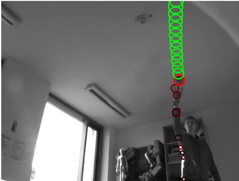
Abbildung 5.1: Beispiel eines erkannten in kräftigem rot Balls mit Vorhersage der Ballflugbahn in grün
