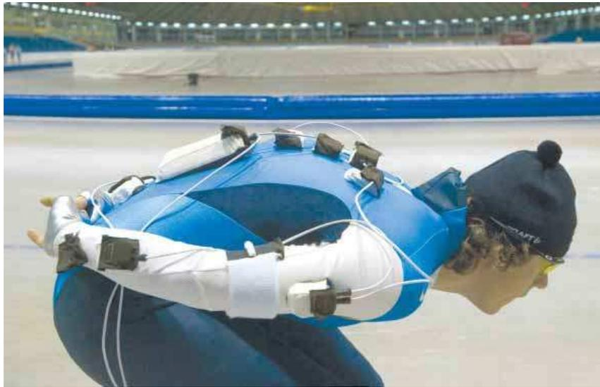
**Abbildung 1.3:** Bewegungsanalyse mit Orientierungstrackern (aus [8]). An relevanten Stellen werden am Anzug des Schlittschuhfahrers Orientierungstracker befestigt. Wie bei *Virtual-Reality* Anwendungen wird jede Gliedmaße in ihrer Richtung (Lage im Raum) observiert. Mit einem darübergerlegten Modell der Gelenke und des Körpers lassen sich die Bewegungen in den Computer übertragen und analysieren, um beispielsweise den Ablauf der Bewegung zu optimieren oder Unregelmäßigkeiten zu erkennen.
