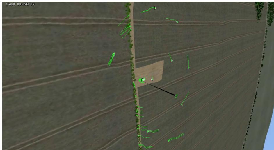
Abbildung 5: Visualisierung des optischen Flusses als grüner Schweif über zehn Frames in einem Ausschnitt der Simulation während einer Drehung des Kites
