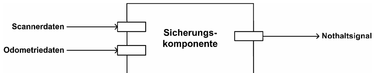
Abbildung 2: Funktionsweise der Sicherungskomponente SAMS
