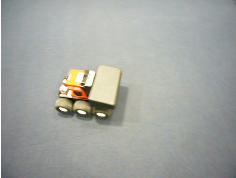
Abbildung 50: Fahrttest zur Bestimmung der Laufzeit der Antriebsakkus
