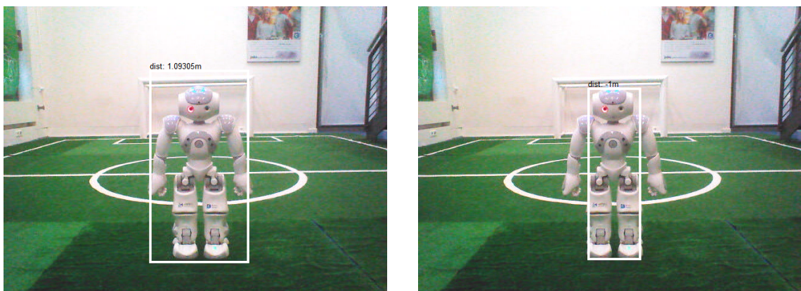
Abbildung 10.4: Vergleich der Bounding Boxes. Im linken Bild ist eine Bounding Box des Roboterdetektors dieser Arbeit zu sehen. Im rechten Bild ist die erkannte Box des aktuellen Robotererkenners von B-Human zu sehen. Die Zahl über der Box zeigt die geschätzte Distanz an, welche nur für den hier entwickelten Roboterdetektor existiert.
