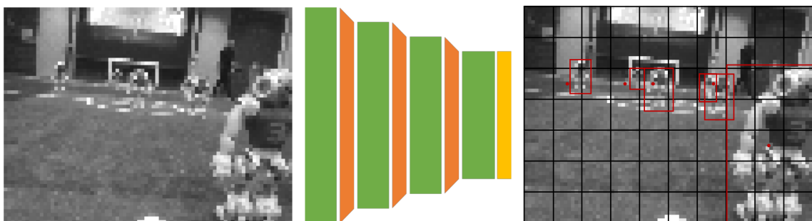
Abbildung 4.5: Übersicht Pipeline. Im ersten Schritt (links) wird das Bild vorbereitet. Anschließend wird es an das neuronale Netz übergeben (mittig). Zum Schluss (rechts) wird die Ausgabe des Netzes so interpretiert, dass Bounding Boxes entstehen.
