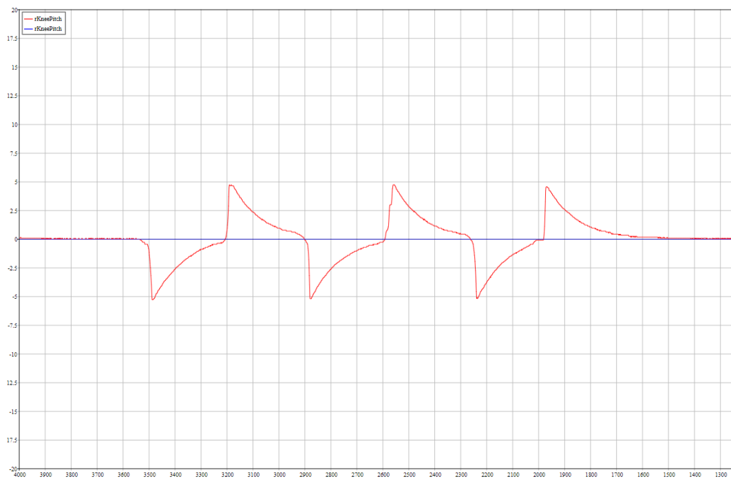
Abbildung 4.3 Ein Gelenk unter leichter Belastung. Die Y-Achse beschreibt die Abweichung von Soll-Ist in Grad, die X-Achse die Anzahl der vergangenen Frames.
