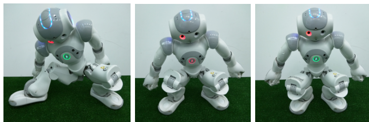
Abbildung 5.12 Bewegung FromSplit Von links nach rechts: Bewegung auf das linke Bein, dann auf das rechte Bein, dann Öffnen des RHipPitch -Gelenkes Auf diese Bewegung folgt das Sitzen und Stehen (siehe Abbildung 5.13)
