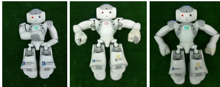
Abbildung 5.11 Back up in der Bewegung Back Von links nach rechts: Arm wird hochgehoben und danach wieder hinter den Rücken bewegt
