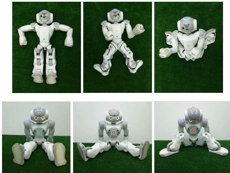
Abbildung 5.7 Bewegung Front Von links nach rechts: Arme nach hinten bewegen und aufrichten Auf diese Bewegung folgt FromSplitt (siehe Abbildung 5.12)
