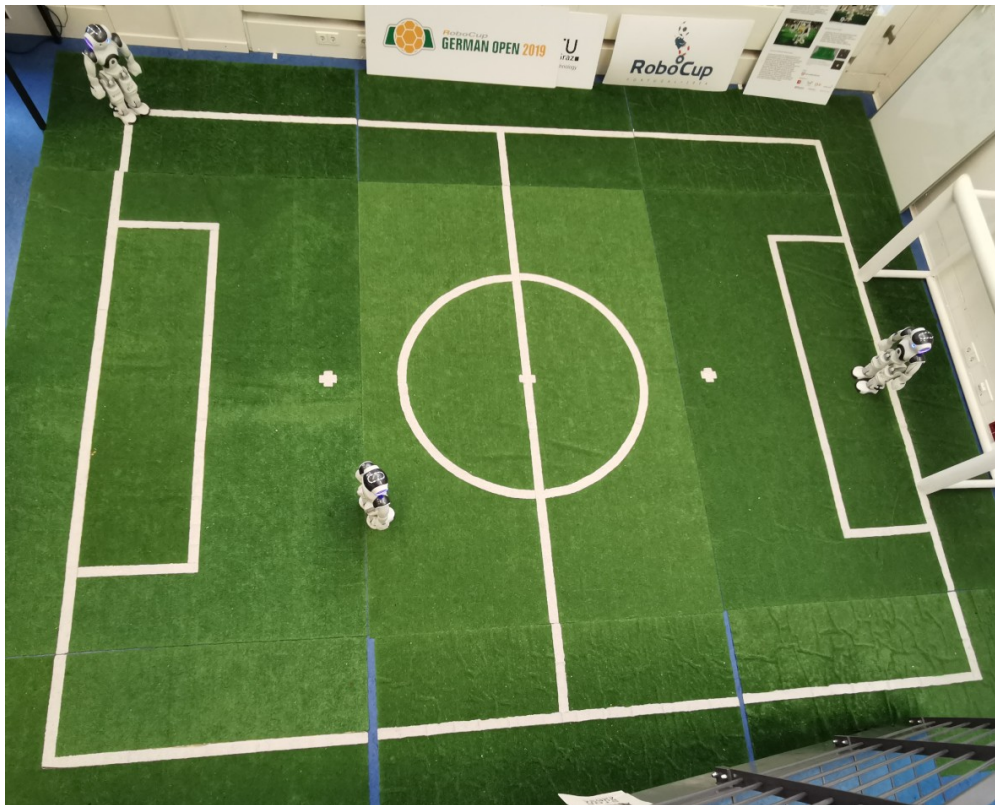
Abbildung 6.2 Versuchsaufbau für eine der Konfigurationen des Experiments. In der hier gezeigten Konfiguration ist der Roboter in der linken hinteren Ecke derjenigen, auf dem das Evaluationsprogramm läuft, während die beiden anderen Ablenkungen für die Merkmalserkennung darstellen sollen.
