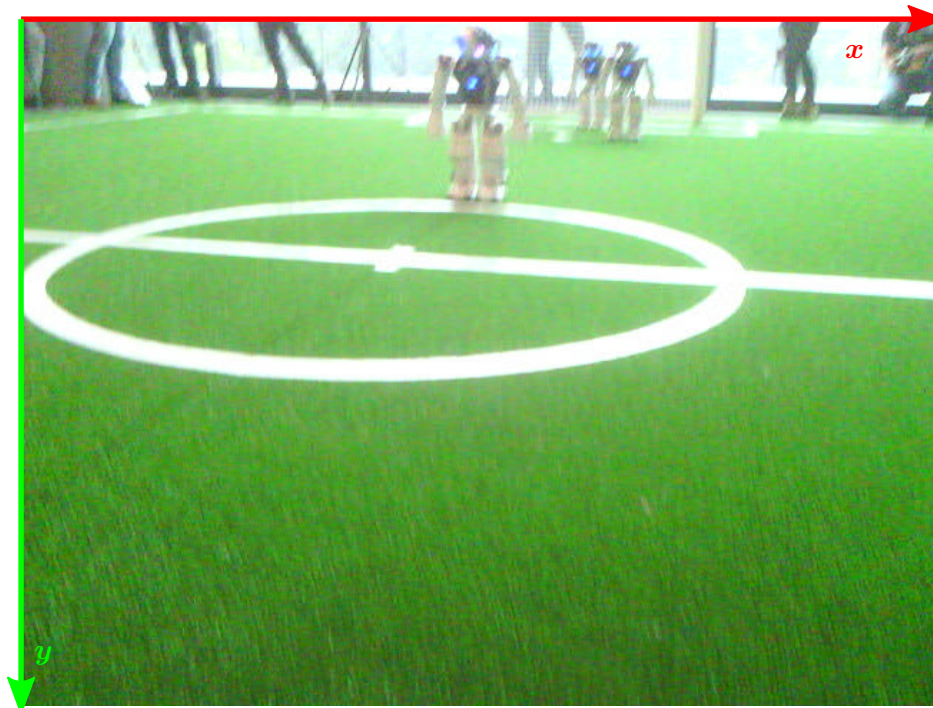
Abbildung 3.3 Veranschaulichung des in dieser Arbeit verwendeten Kamerabildkoordinatensystem.
