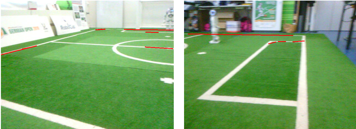
Abbildung 6.3 Vom Linienerkennungsnetz gesehene, in das Kamerabild zurückprojizierte Feldlinien. Es zeigt sich, dass Linienabschnitte zwar korrekt erkannt werden – teils sogar wie im rechten Bild durch Hindernisse hindurch –, diese aber in der Regel zu kurz sind, um aus ihnen komplexere Bodenmerkmale zu bilden.
