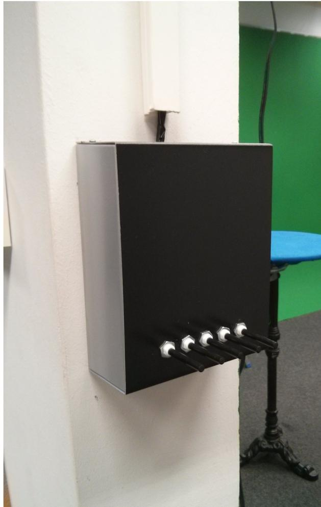
**Abbildung 3.13: Bediener-Schnittstelle der Steuerung**
