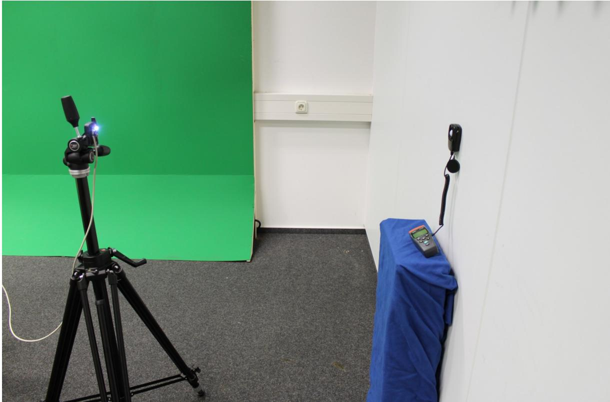
**Abbildung 4.1: Versuchsaufbau zur Messung der Lichtverteilung**
