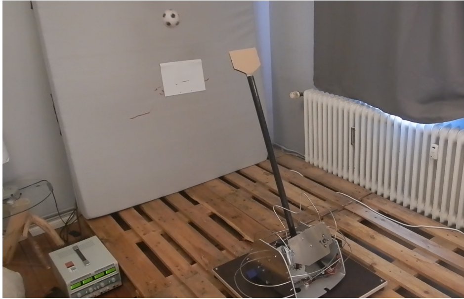
Abbildung 28: Schlagversuch mit Ball an der Schnur
