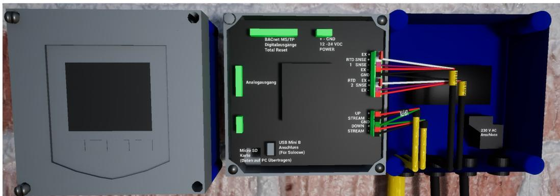
Abbildung 32: Der TFX-5000 Messwertumformer, links die geschlossene Front, rechts offen. Mit montierten Kabelenden und Brücken.
