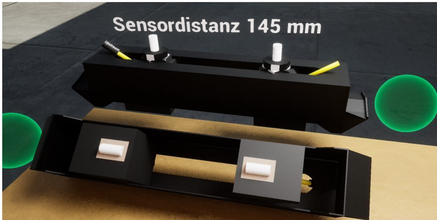
Abbildung 33: Der DTTR-Sensor, im Bild vorne die Unterseite mit Koppelpaste, hinten die Seitenansicht.
