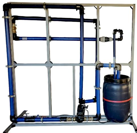
Abbildung 46: Das fertige Gestell mit montierter Rohrleitung.
