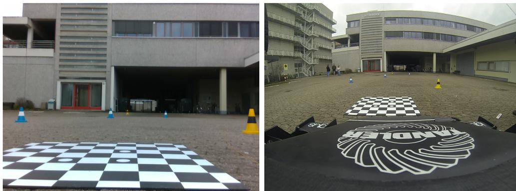
**Abbildung 4.3:** Vergleich der Referenzpunktverteilung zwischen der Kamera im Frontwing (links) und der Kamera am Engine Cover (rechts).
