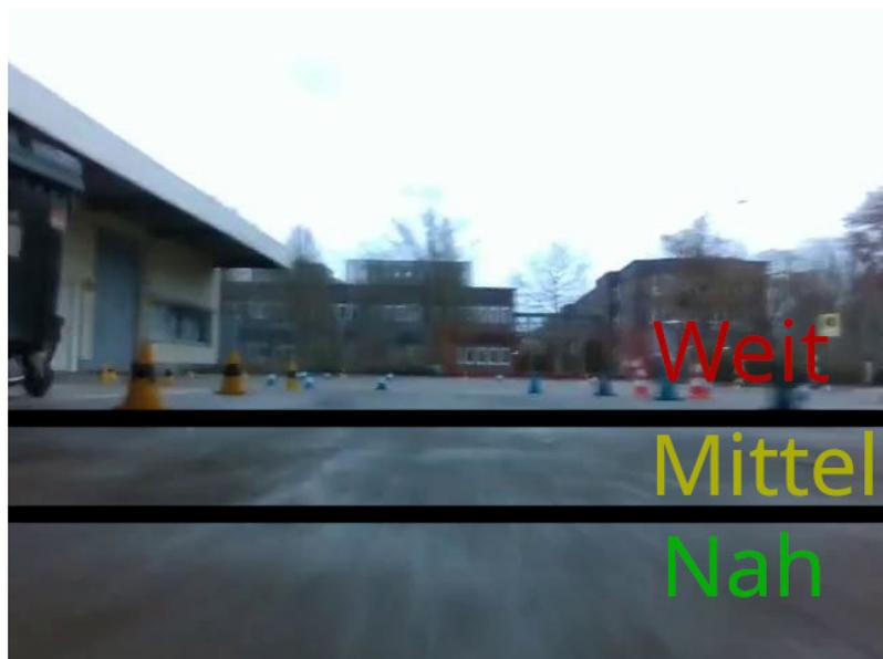
**Abbildung 4.11:** Distanzgruppen der Evaluation am Beispiel der Frontwing Kamera.
