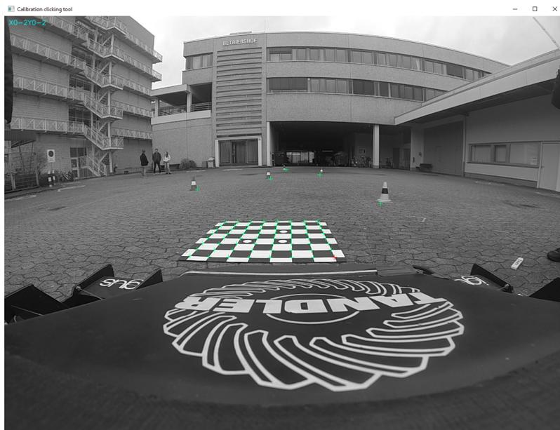
**Abbildung 4.5:** Script zum Einlesen der Kalibrierungsdaten, hier am Beispiel der Engine Cover-Kamera. Durch Klicken setzt man ein grünes Kreuz. Jedes grüne Kreuz entspricht einem Bild-Referenzpunkt, für welchen Realwelt-Koordinaten vorliegen.
