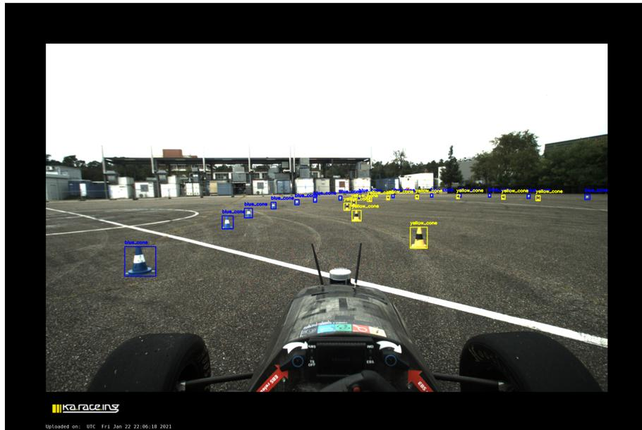
**Abbildung 3.3:** Ein Beispielbild aus dem FSOCO Datensatz mit annotierten Pylonen.
