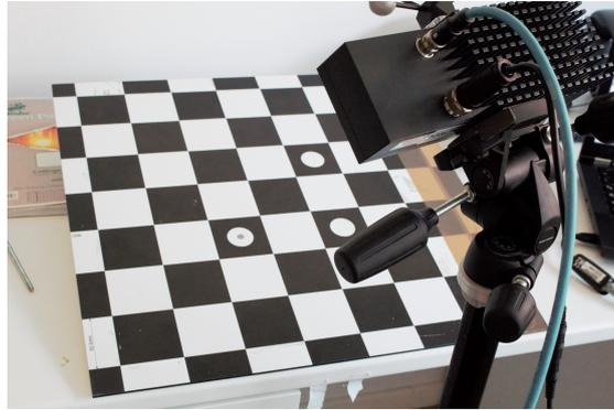
Abbildung 5.3: Aufbau zur Evaluation der Target-Kamera Kalibrierung
