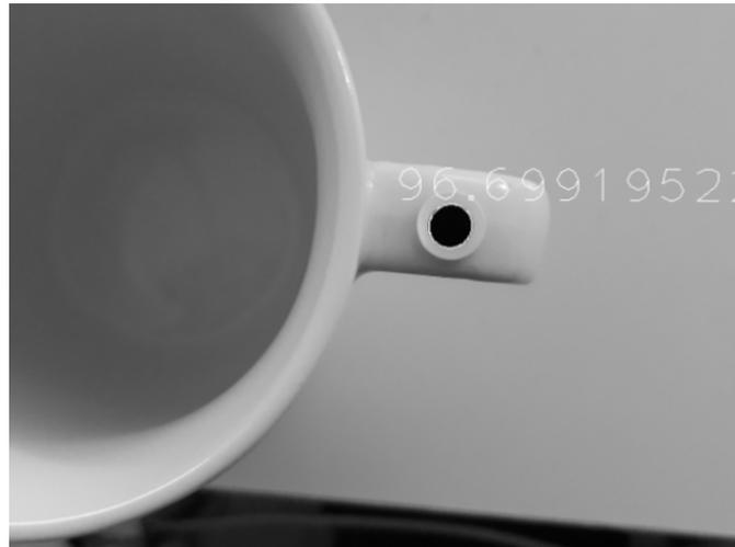
Abbildung 6.1: Erkannter Marker und berechnete Distanz zum Smartphone
