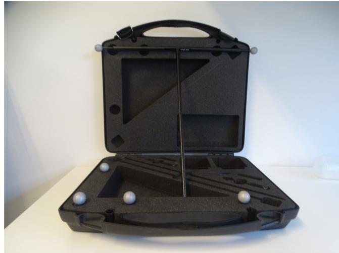
Abbildung 5.1: Hardware zum Kalibrieren des Tracking-Systems
