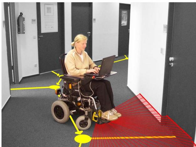
**Bild 2** ROLLAND 3 (MEYRA [7]) mit Routengraph
