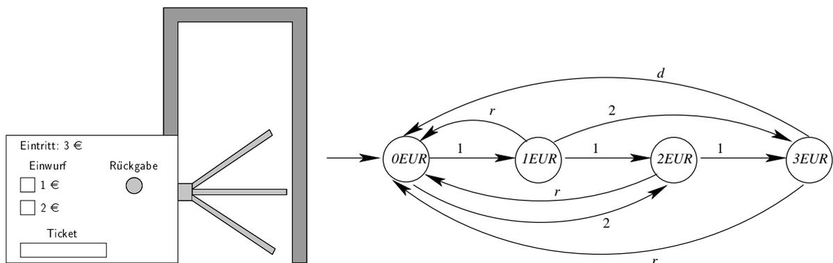
Der dargestellte Automat regelt eine Drehsperre. Es können Münzen im Wert von 1 oder 2 Euro eingeworfen werden. Nach Einwurf von 3 Euro wird die insgesamt Arretierung der Drehsperre gelöst und der Eintritt freigegeben. Der Automat gibt kein Wechselgeld zurück sondern nimmt einen zu hohen Betrag einfach nicht an (Münzen fallen durch). Man kann jederzeit den Rückgabeknopf drücken, um den bereits gezahlten Betrag zurückzuerhalten.
