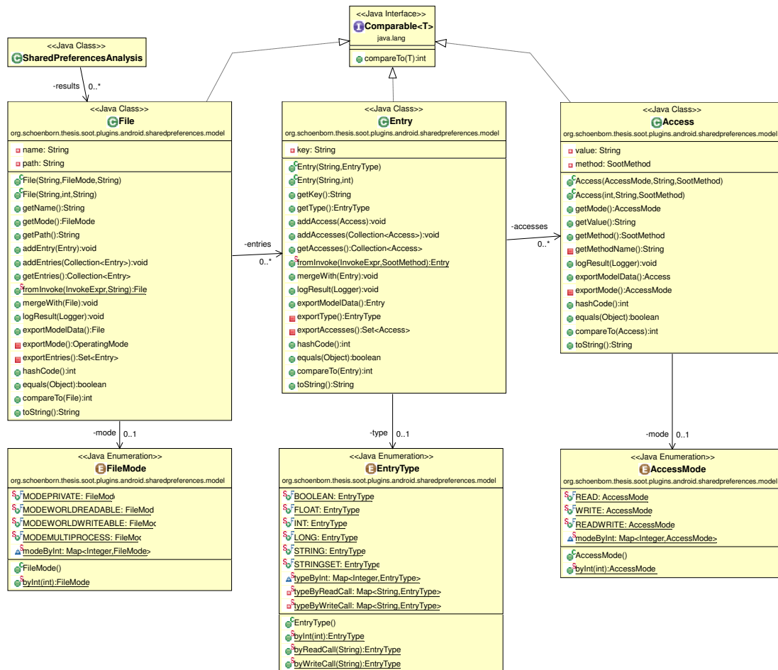
Abbildung 3.3: UML-Darstellung der Implementierung (Datentyp-Klassen)
