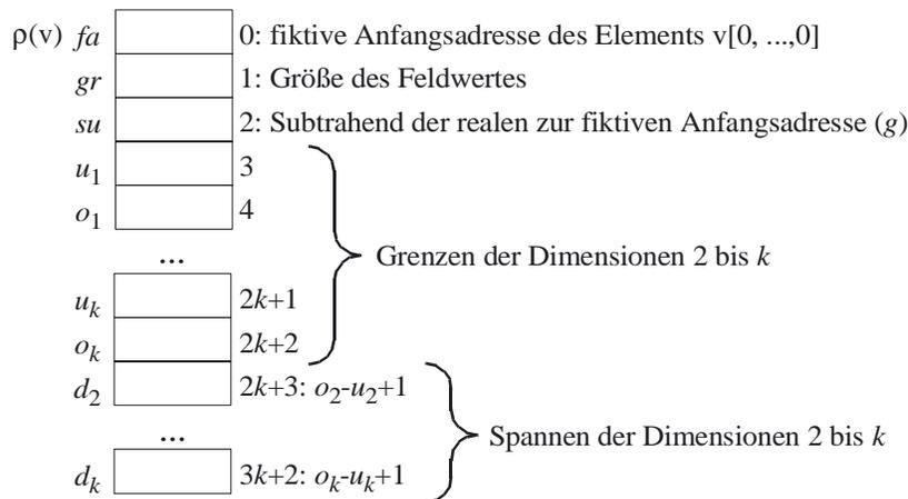
Nimm die Formel zur Berechnung der relativen Adresse eines Feldelementes  $v[e_1, e_2, \dots, e_k]$  für statische Felder (siehe Vorlesung und Folien) und berechne den von den Feldindizes abhängenden Teilwert mithilfe eines Hornerschemas. (Der Rest,  $g$ , ist im Deskriptor abgespeichert.)
