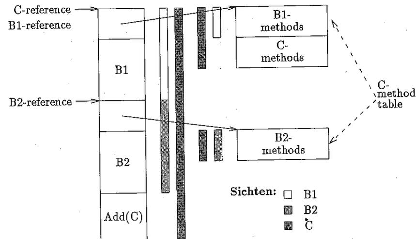
Abb. 5.9: Objektaufbau bei unabhängiger mehrfacher Beerbung (tatsächliche Implementierung)
