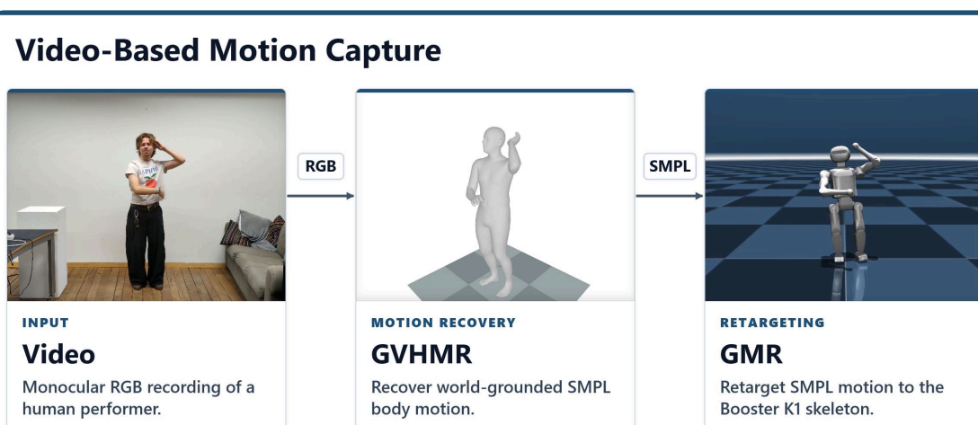
Abbildung 3: Videobasierte Bewegungserfassung: GVHMR rekonstruiert die menschliche Bewegung, GMR überträgt sie auf die Kinematik des Booster K1 (eigene Darstellung)
