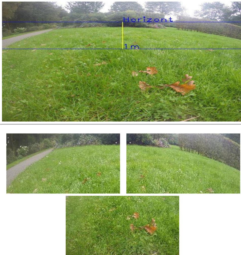
Abbildung 5.28: Aufteilung des Bildes in drei gleich skalierte Teilbilder. **Oben:** Skizzierung der Trennlinien, so dass die Seitenverhältnisse aller Teile ähnlich bleiben, um Verzerrung durch Skalierung zu verringern. **Unten:** Aufgeteilte und skalierte Eingabe.
