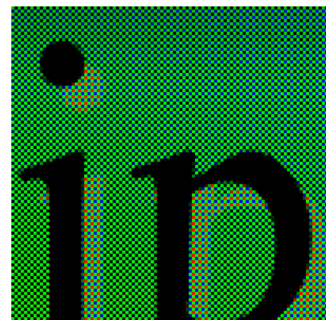
Bild durch Bayer Filter: Rote, Grüne und Blaue Punkte
