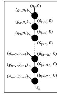
Fig. 2. Serial prefix adder
